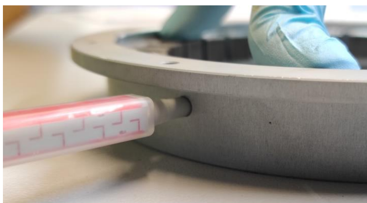
Рисунок 2.2. Введение эпоксидного клея в отверстие корпуса статора.
